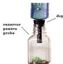
Fig. 12. Montaj pentru colectarea probelor de gaz CO 2 la germinarea boabelor de mazăre
