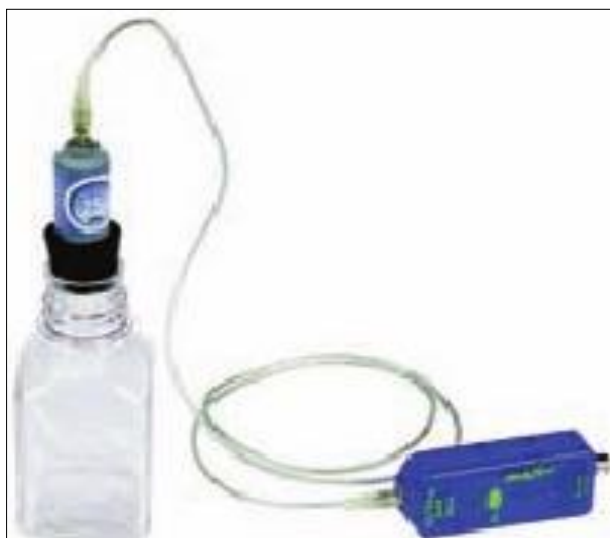
Fig. 10. Asamblarea senzorului pentru măsurarea concentrației de oxigen
